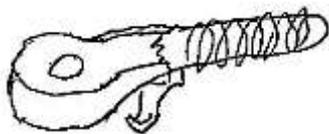
レバーの先端を追加補修（概略図）
