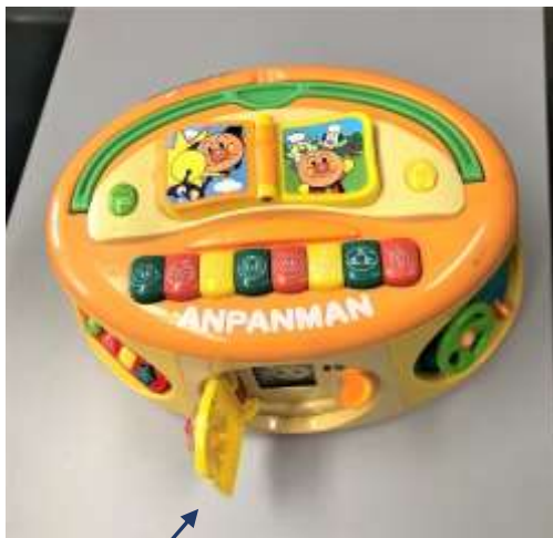
ドアが閉まらない
